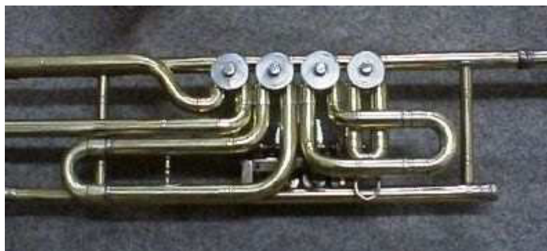
Particolare della "macchina" di un trombone a quattro cilindri a sistema "bavarese" di Anton Schöpf, Landshut, ca. 1885
